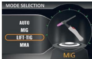
La méthode TIG est particulièrement recommandée pour l'assemblage esthétique et de haute qualité des métaux, sans traitement mécanique à forte intensité de main-d'œuvre après le soudage. Cependant, cela nécessite une préparation et un nettoyage appropriés des bords des deux éléments soudés. Les propriétés mécaniques du matériau d'apport doivent être similaires à celles des pièces à souder. Le gaz inerte est de l'argon pur, fourni en quantité dépendant du courant de soudage réglé.
