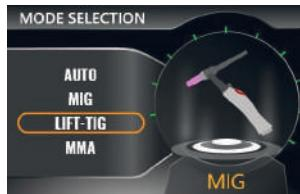
Das TIG-Verfahren wird besonders für ästhetisches und hochwertiges Fügen von Metallen ohne arbeitsintensive mechanische Bearbeitung nach dem Schweißen empfohlen. Dies erfordert jedoch eine entsprechende Kantenvorbereitung und -reinigung der beiden zu schweißenden Teile. Die mechanischen Eigenschaften des Zusatzwerkstoffes müssen denen der zu schweißenden Teile ähnlich sein. Als Schutzgas wird hier reines Argon eingesetzt, das in Abhängigkeit vom eingestellten Schweißstrom zugeführt wird.
